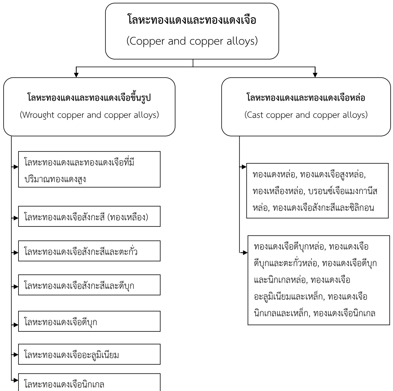
รูปที่ 2.8 การแบ่งประเภทของโลหะทองแดงและทองแดงเจือ ที่มา : Copper Development Association (CDA)
